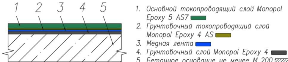
По подготовленному основанию поклеить самоклеящуюся медную ленту и прикатать ее уплотняющим валиком для плотного прилегания к основанию. Соединение двух участков лент должно выполняться внахлест. Приклеивание ленты выполняется с отступом от стен и колонн на 20-30 см, сеткой со стороной квадрата 2-3 метра.
